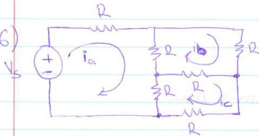
a) Mesh A:  $-V_s + Ri_a + R(i_a - i_b) + R(i_a - i_c) = 0$
