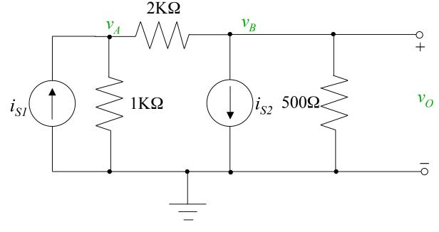
$$\begin{pmatrix} 1.5 \times 10^{-3} & -0.5 \times 10^{-3} \\ -0.5 \times 10^{-3} & 2.5 \times 10^{-3} \end{pmatrix} \begin{pmatrix} v_A \\ v_B \end{pmatrix} = \begin{pmatrix} i_{S1} \\ -i_{S2} \end{pmatrix}$$
