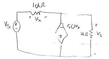
$$V_{5} - V_{x} - V_{0} = 0 -50V_{x} = V_{0}$$
